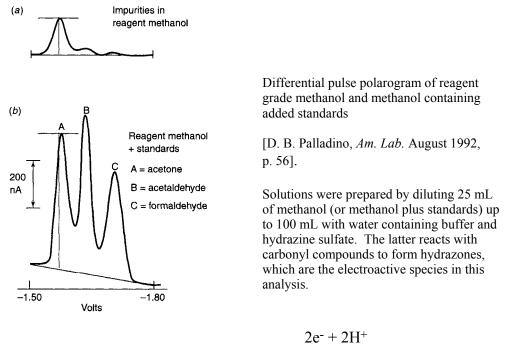
$\begin{array}{cccc} (CH_3)_2C=O &+ &H_2N-NH_2 & \rightarrow & (CH_3)_2C=N-NH_2 & \rightarrow & (CH_3)_2CH-NH-NH_2 \\ Acetone & &Hydrazine & Acetone hydrazone & & & \end{array}$
